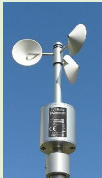
Εικόνα 1. Κυπελλοφόρα ανεμόμετρα (όργανα μέτρησης της έντασης του ανέμου).
